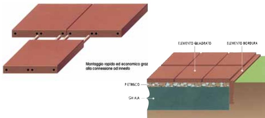
Il pavimento antiurto in granolato di gomma è una pavimentazione particolarmente elastica, studiata appositamente per assorbire gli urti e smorzare l'impatto con il suolo in caso di caduta in base alla norma EN 1177. Può essere adottata come valida alternativa alla sabbia o all'erba nel rivestimento della superficie occupata dai giochi Pircher Tartaruga.
